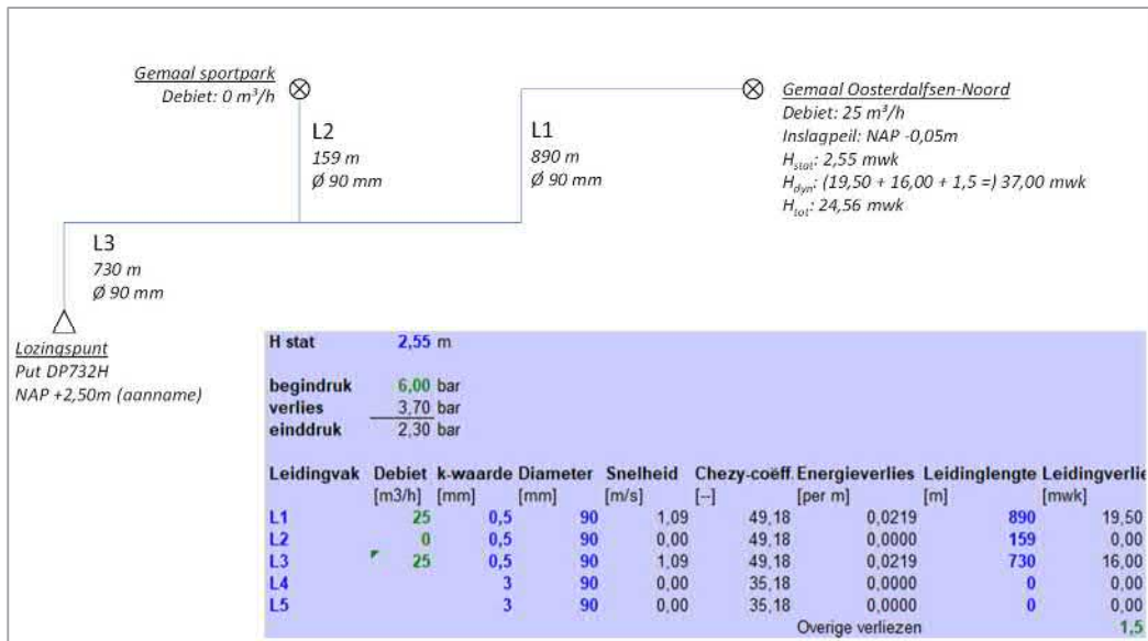
Figuur 5.2: Hydraulische berekening gemaal Oosterdalfsen Noord
