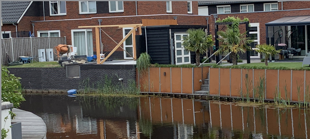
Ongewenste voorbeelden van hoge kadewand over de hele kavelbreedte. Dit is maximaal 1/2 van de kavelbreedte toegestaan (1e fase Westerbouwlanden)
