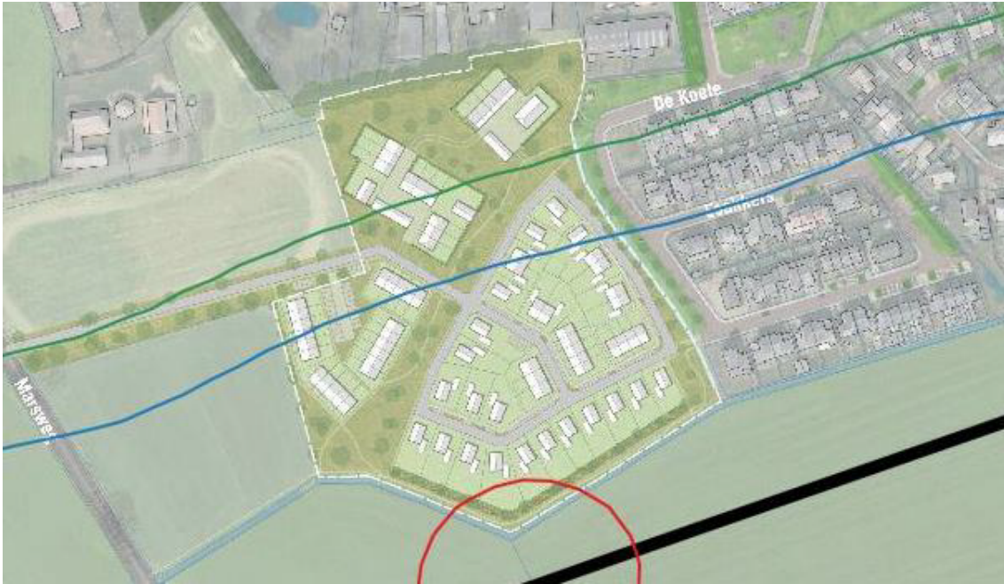
Figuur 4.5 Plangebied met PR-contouren A-595 (ten tijde van het uitvoeren van het onderzoek naar externe veiligheid was het stedenbouwkundig plan nog niet definitief. Op deze afbeelding is een eerdere versie zichtbaar)
