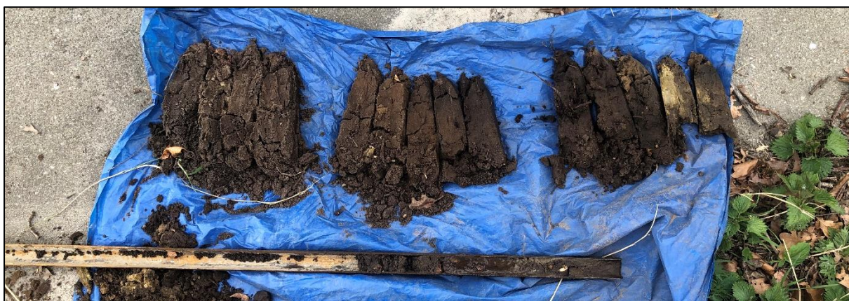
Boring 6: 0-200 cm -Mv. Dieper gelegen sediment loopt uit boor onder invloed van grondwater.
