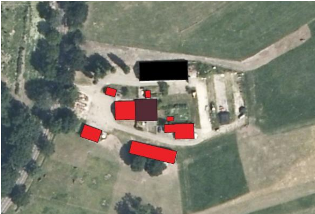
Figuur 2. De te slopen bebouwing (rood), te vervangen woning (paars) en te handhaven bebouwing (zwart) (bron: Eelerwoude, 09-12-2010).
