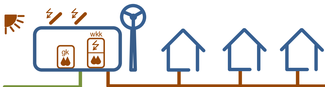
Figuur 5.5 Schematische weergave energieconcept 5, bio-WKK
