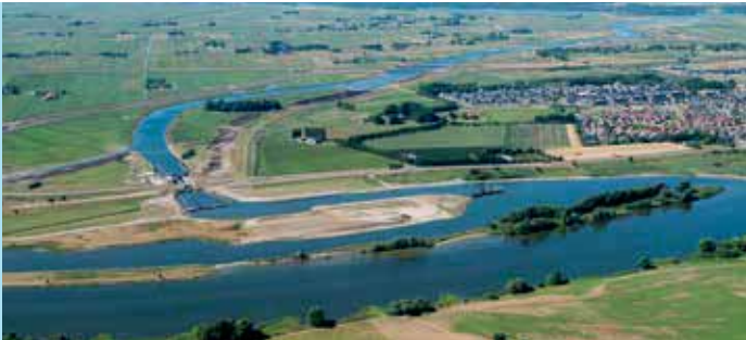
Ruimte voor de Rivier 2.0 (meer ruimte in uiterwaarden, dijkverlegging, bypass, dijken ophogen, ...).
