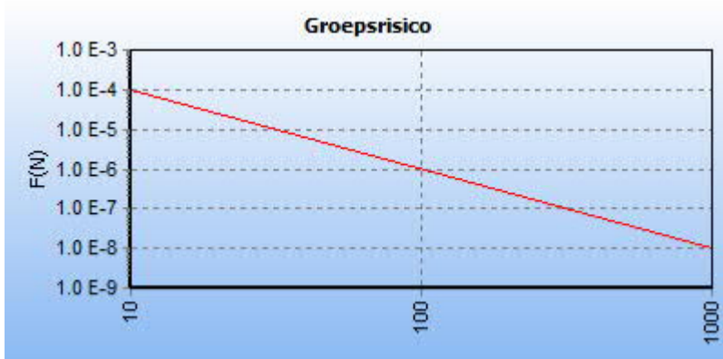
5.7 Figuur 5.7 FN curve voor 8393_leiding-A-528-01-deel-1 van N.V. Nederlandse Gasunie voor de kilometer tussen stationing 0.00 en stationing 1000.00
