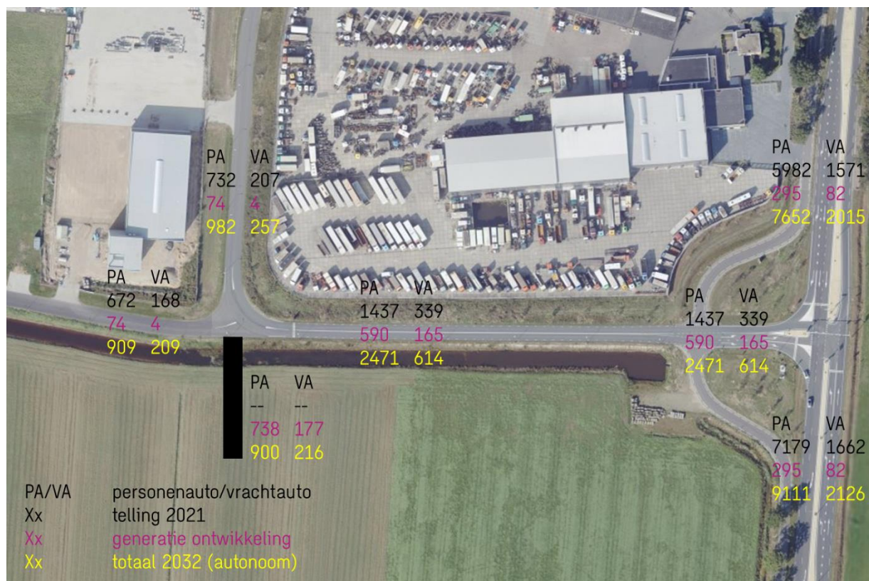
Figuur 4.4 : de huidige, nieuwe en totaal aantallen over 10 jaar van het verkeer, per wegvak (bron: Cyclomedia)
