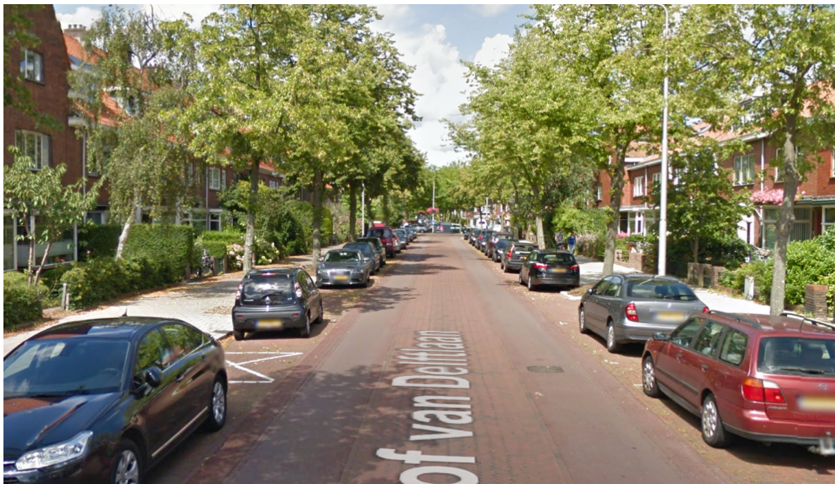
Afbeelding 8: Referentie klinkers in combinatie met asfalt fietslopers (Hof van Delftlaan, Delft)
