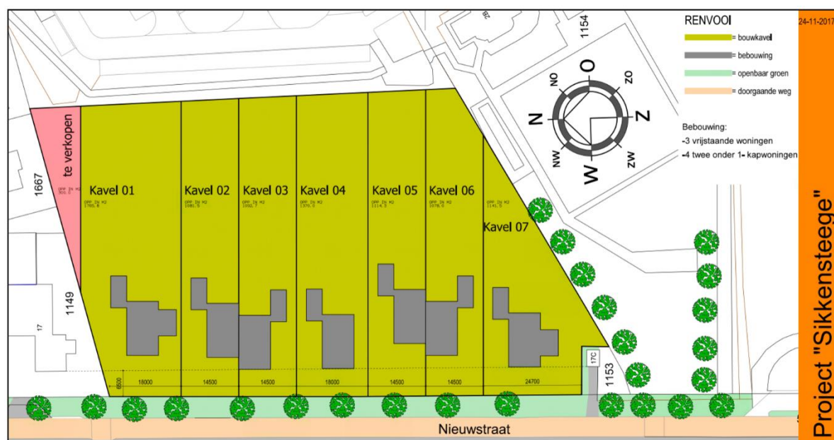
Figuur 3.1 Verkaveling variant 1 (bron: Bouwkundig bureau BAT)
