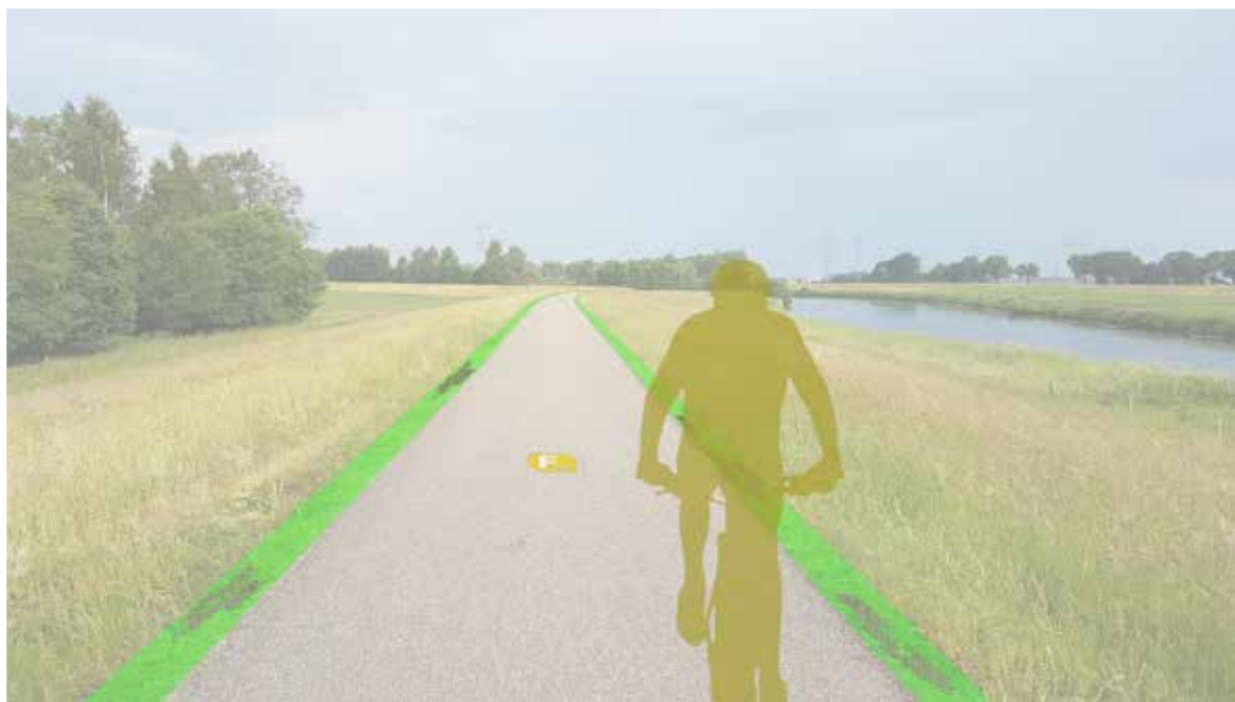
korte termijn: grasbetonstenen aanbrengen
